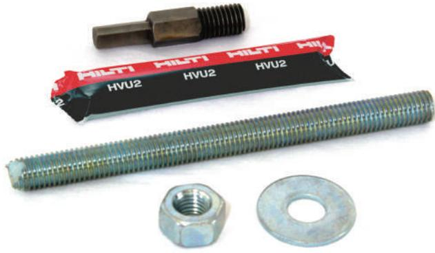
提供了一種高強度的重型錨固方法，透過使用高強度黏合劑將螺桿和其他材料（如鋼筋）固定在混凝土或其他磚石材料中，該系統包括一個錨固膠劑，內含適當比例的基礎樹脂、固化劑和錨固骨材，還有一個適當長度的雙頭螺絲附有墊圈和螺帽，以及一個可將雙頭螺絲插入標準鑽頭的驅動裝置。
